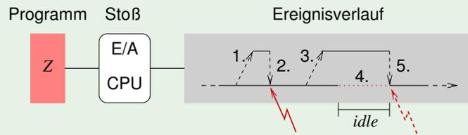
1. Programm Z löst einen zum CPU-Stoß nebenläufigen E/A-Stoß aus
