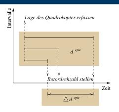
d<sup>cpu</sup> Auch bei konstantem Rechenaufwand zur Stellwertbestimmung variabel
