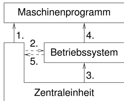
*In Phase 1. ist nur eine Teilmenge von Ebene<sub>2</sub>-Befehlen direkt von der CPU ausführbar, in Phase 3. dagegen alle.*
