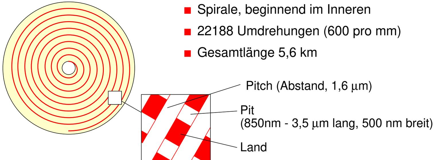
■ **Pit:** Vertiefung, wird von Laser (780 nm Wellenlänge) abgetastet
